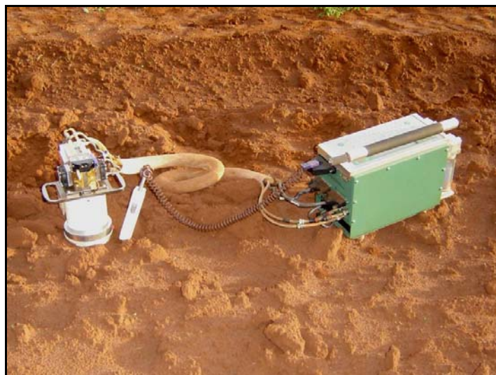
Fig. 02 - Câmara de solo inserido sobre o colar de PVC (esquerdo) com sensor de temperatura inserido no interior do solo (centro).
